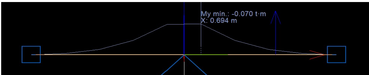
DIAGRAMA DE MOMENTO FLETOR NO EIXO X (EIXO PERPENDICULAR A DIREÇÃO DE 3,2m). PARA UMA FAIXA DE 0,5m DE LAJE, LOGO: 0,070/0,5 = 0,140\text{tfm} POR METRO DE LAJE.
