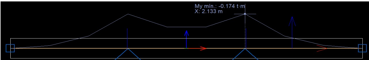
DIAGRAMA DE MOMENTO FLETOR NO EIXO Y (EIXO PARALELO A DIREÇÃO DE 3,2m). PARA UMA FAIXA DE 0,5m DE LAJE, LOGO: 0,174/0,5 = 0,348\text{tfm} POR METRO DE LAJE.
